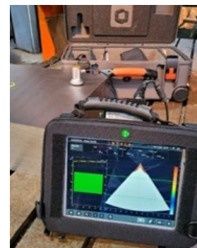
Estrutura uniforme permite um excelente ensaio de ultrassom. Equipamento (Mentor GE)
