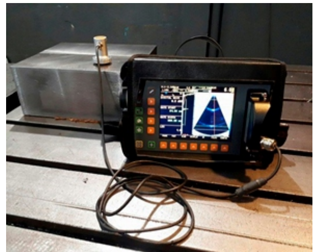
Ultrassom de última geração (PHASED ARRAY) com captação de imagem do defeito
