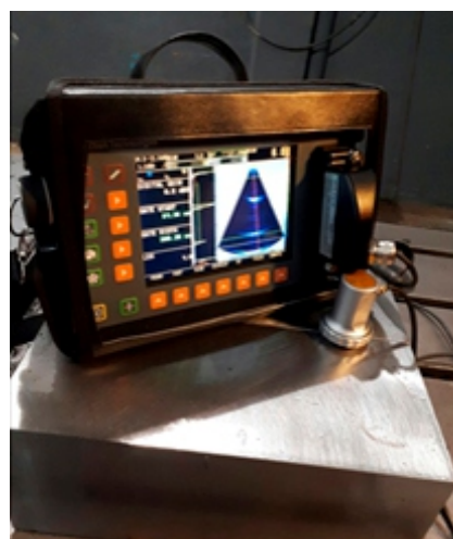
Ultrassom de última geração (PHASED ARRAY) com captação de imagem do defeito
